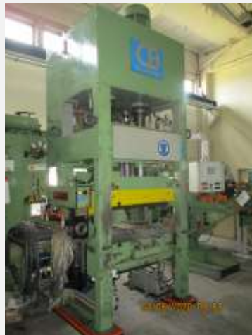
Hylatechnik, HESSP 100 , hydr. Schnellläufer Stanz- u. Umform- Tisch 1000x700, Schnittschlagd. Walzenvors., Schallschutzkabine
