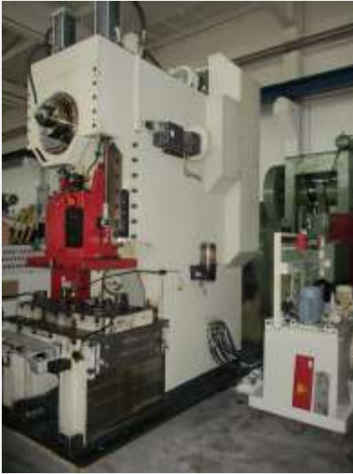
Heilbronn, REP 160 , Bj.1995 CE, hydr. Kupplung, pneum. Stößel- gewichtsausgleich, halbautom. Hubverstellung
