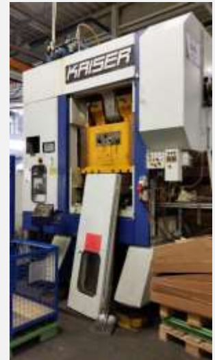
Kaiser, V 160 W/1030 , Bj.80 überh. 2013, schallgedämmte Ausführ., motor. Stößelverstell. Überlastsicherung, m. Bandanlage
